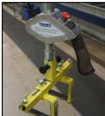
Gabelwerkzeug wird zum Heben von Aluminiumprofilen angewandt.
