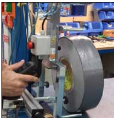
Rollenhandling mit pneumatischem Greifer / Heben von Papierrolle mit justierbarer Joystick-Steuerung.
