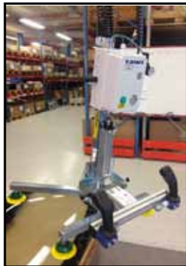
Heben einer Windschutzscheibe: Anwendung mit der dualen Joystick-Steuerung.
